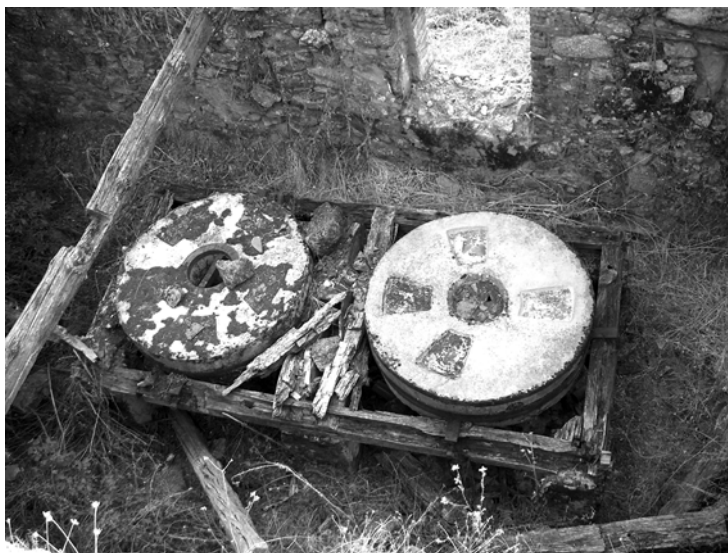
Imagen de los dos pares de muelas (francesas tipo La Ferté-Sous-Jouarre) que aún se conservan en el molino de la garganta de la Eliza (Lanzahíta).
