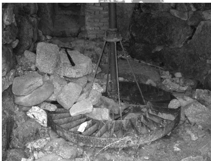
Rodezno de alabes rectos, conservado en el molino de la garganta de la Eliza (Lanzahíta).
